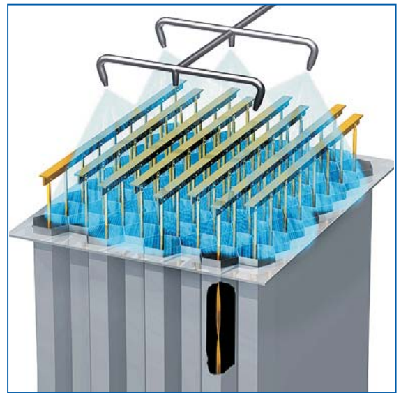
Abreinigung der wabenförmigen Niederschlags Elektroden sowie der Sprühelektroden durch ein periodisch wirkendes Spülwassersystem
